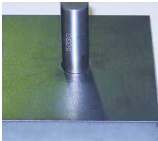
С технологией True Hole, резка с помощью плазмы HPRXD
